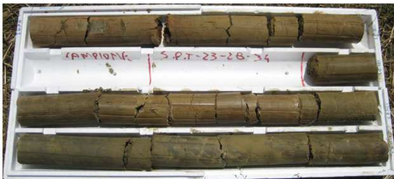
SONDAGGIO 4 - PROFONDITÀ 24.00 M - 28.00 M
