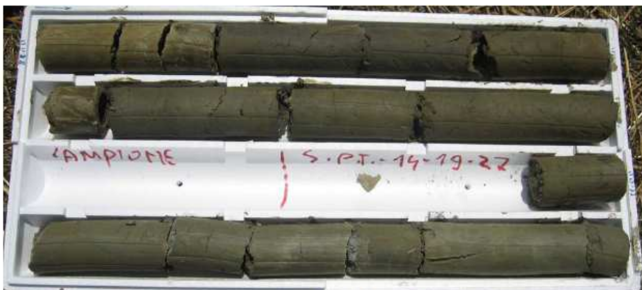
SONDAGGIO 4 - PROFONDITÀ 8.00 M - 12.00 M
