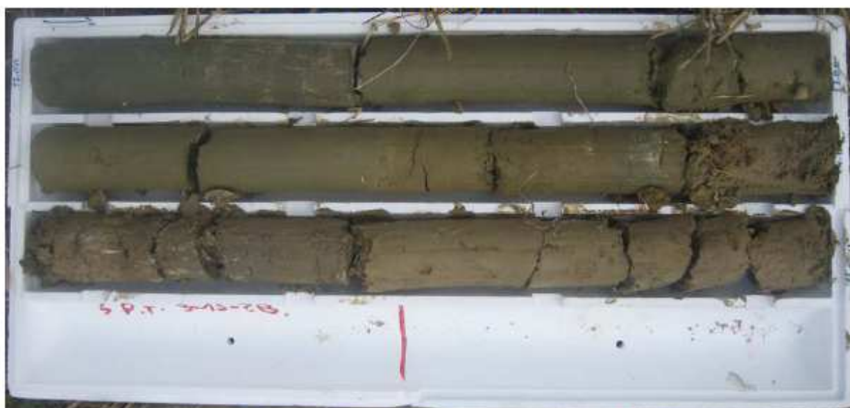
SONDAGGIO 2 - PROFONDITÀ 12.00 M - 15.00 M
