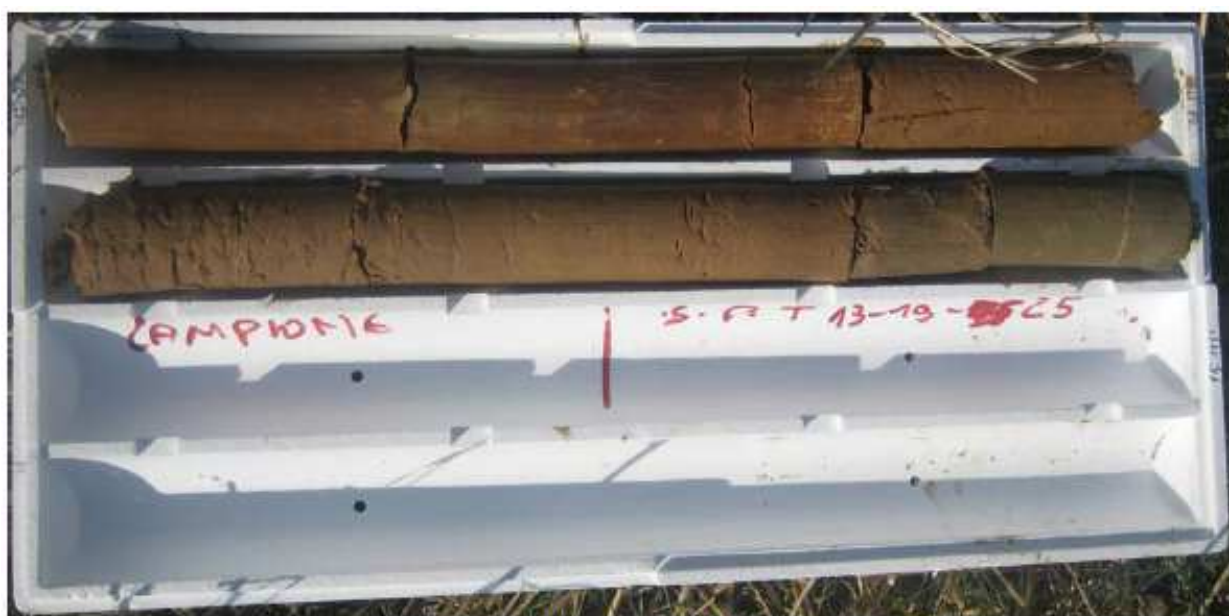
SONDAGGIO 3 - PROFONDITÀ 12.00 M - 15.00 M
