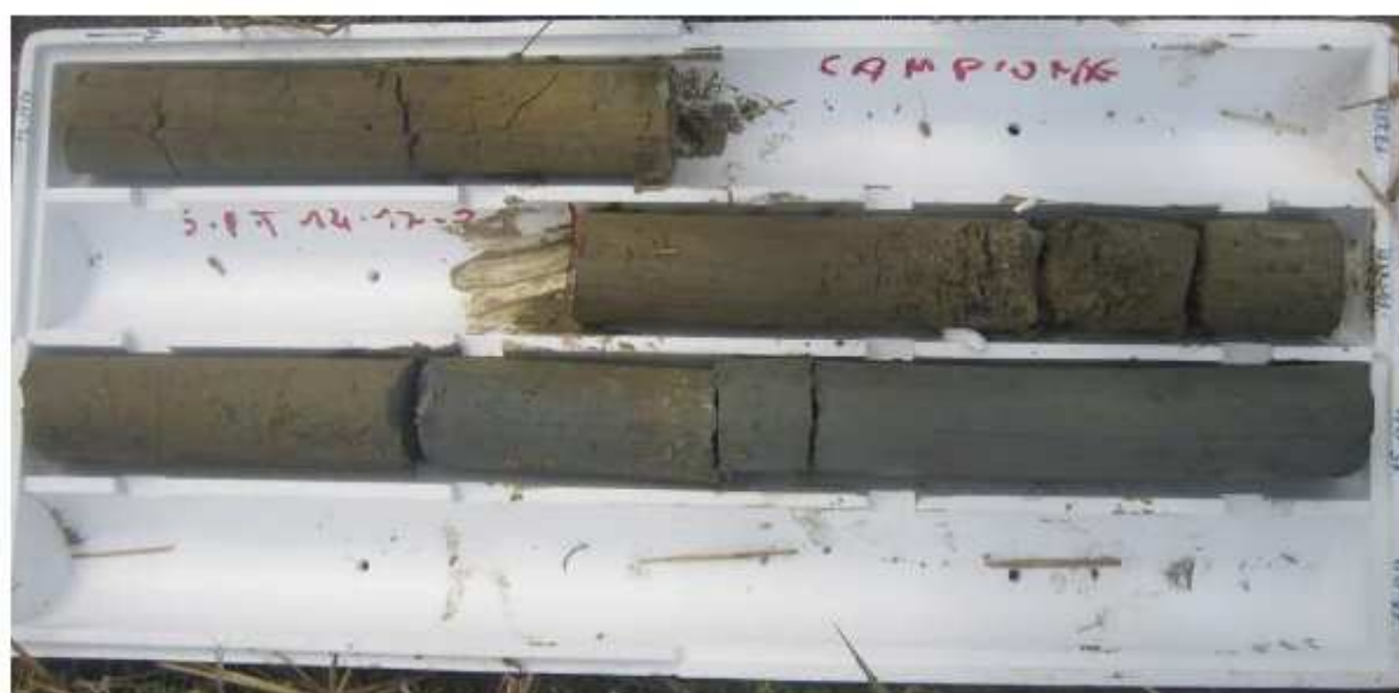
SONDAGGIO 1 - PROFONDITÀ 12.00 M - 15.00 M
