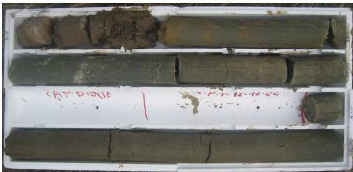
SONDAGGIO 2 - PROFONDITÀ 8.00 M - 12.00 M
